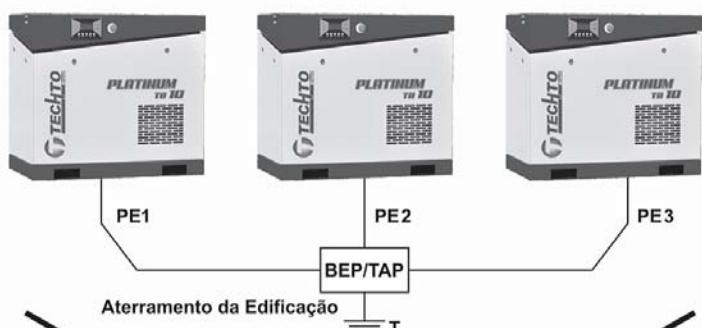
Conexão em série dos cabos de Aterramento (errado)
